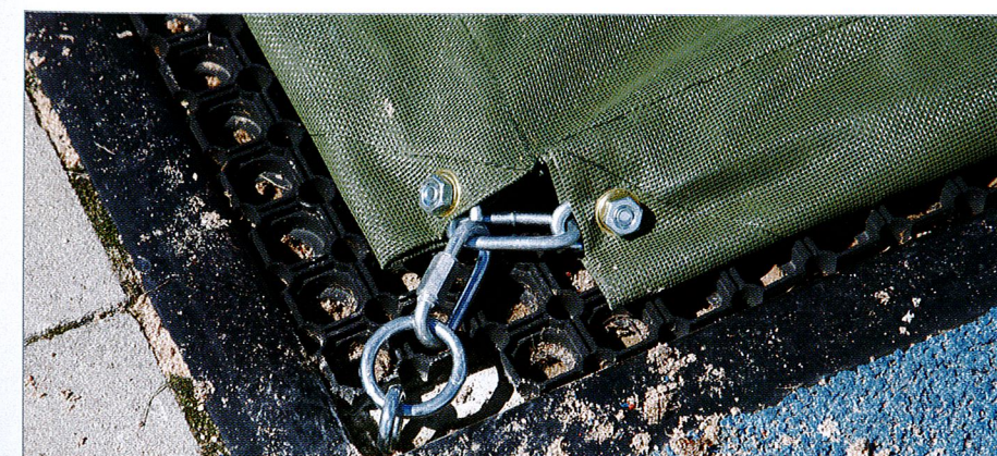
Variante zur Eckbefestigung der Beschwerungskette
